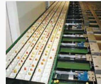
Kettenschmierung im Nassbereich der Lebensmittelindustrie (Apfelsortierung)
