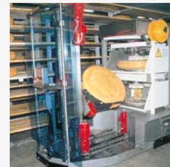
Schmierung von hochbelasteten Gelenken und Führungen an Käse-laibwenderobotern
